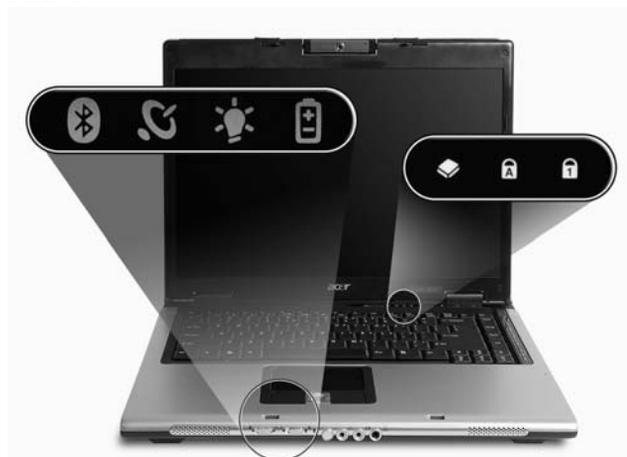
Les indicateurs d'état de l'alimentation, de la batterie et de la communication sans fil sont visibles même lorsque l'écran LCD est fermé.
